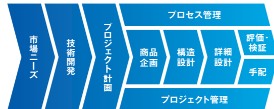
スピーディかつ高品質な製品開発をするためのプロセス
